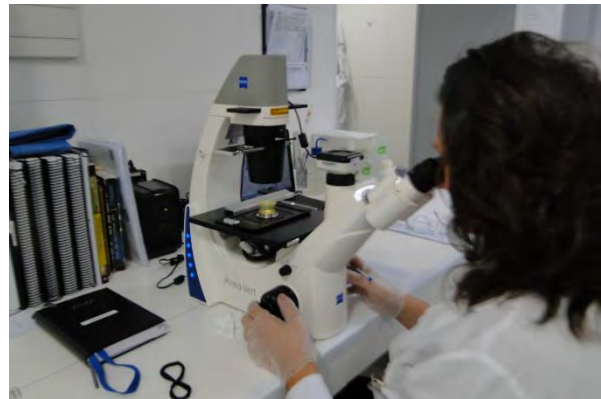
Fotos 3.2.1-2 e 3.2.1-3. Amostra na câmara de sedimentação de Utermöhl e contagem do fitoplâncton em microscópio invertido.
