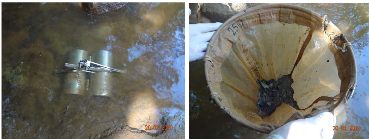
Fotos 3.2.3-1 e 3.2.4-2. Coleta de sedimentos para análises de invertebrados bentônicos com amostrador Petersen e lavagem de sedimento em campo.
